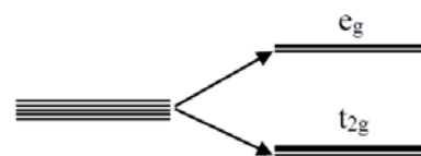
図 4 正八面体構造の錯体における d 軌道のエネルギーレベル。 t_{2g} と e_g は群論の記号である。
